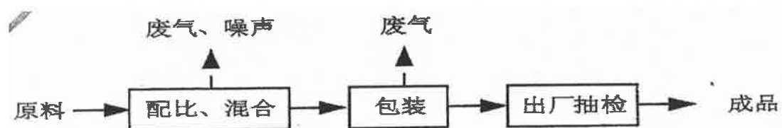
图 4-1 热熔涂料生产工艺流程图
